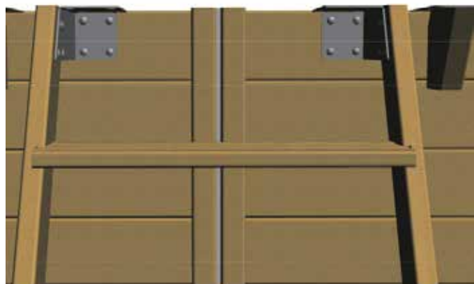
Anbringen der Außentreppe am Becken
