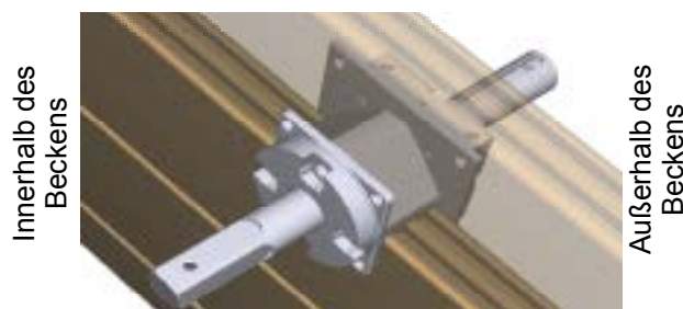
Abbildung 40 – Montage der Welle an der automatischen Abdeckung
