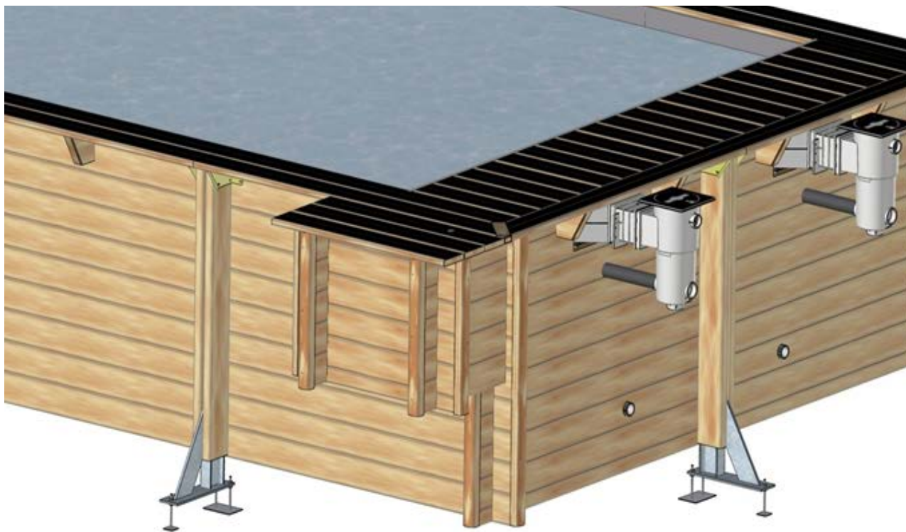
Abbildung 58 – Lage des Motorschachts am Pool
