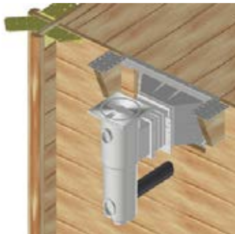
Abbildung 25 – Montage der Skimmer-Halterung
