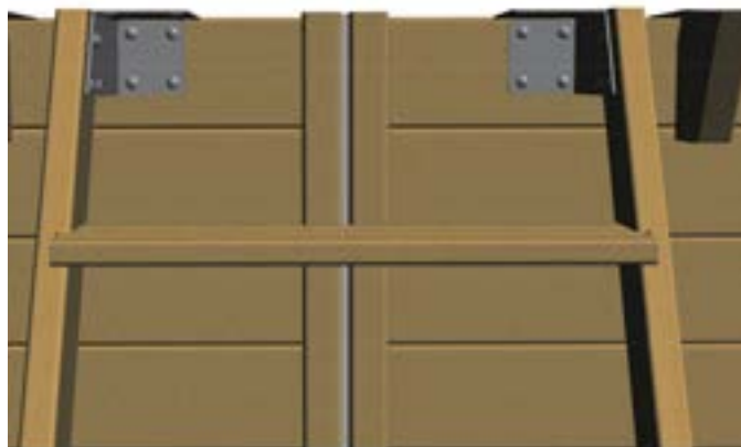
Abbildung 18 – Anbringen der Außentreppe am Becken
