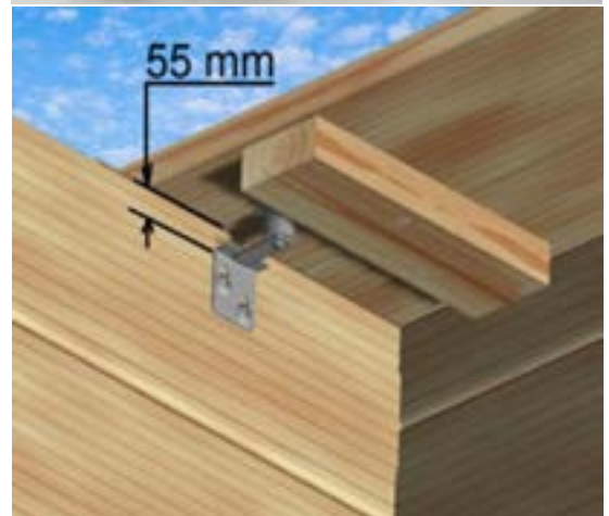
Abbildung 68 – Montage des Schließmechanismus
